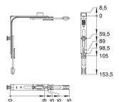
Für Fenstergetriebe Eckumlenkungen Anschlussschienen In verschiedenen Ausführungen Für Montage oben/unten
