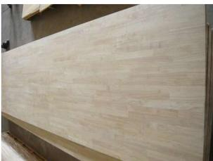
Leimholzplatten sind einlagige Massivholzplatten, deren Holzleisten über die Schmalseiten verleimt werden. Die Leimholzplatte zeichnet sich durch ihre hohe Festigkeit in Faserrichtung aus.
