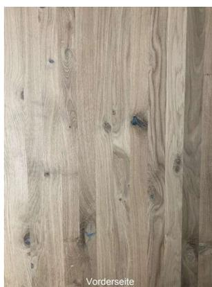
Leimholzplatten sind einlagige Massivholzplatten, deren Holzleisten über die Schmalseiten verleimt werden. Die Leimholzplatte zeichnet sich durch ihre hohe Festigkeit in Faserrichtung aus.
