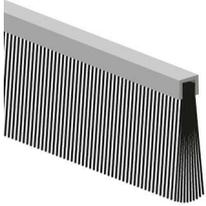
Elton IBS31 Bürstendichtung ohne Halteprofil mit strapazierfähiger Bürste aus Hartpolypropylen zum Einnuten Gesamthöhe:17,5mm Bürstenhöhe 13,5mm Länge 2500mm 7201002
